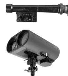
Fototelefono Zeiss, 1937. Nippon Kogaku ne ha realizzati di simili per l'esercito. Sopra, mirino di precisione Tipo 47 da carabina. In alto, nella sua cassa, uno dei vari bombsight realizzati da Nippon Kogaku. Si tratta del Shibaku Tipo 2, Mark 1 che veniva montato all'esterno della carlinga dei cacciabombardieri Nakajima come mostra la fotografia a accanto.
